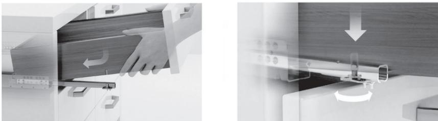
Выдвижной ящик фиксируется благодаря установочным цапфам, а точная высота настраивается с помощью регулировочного колесика.
